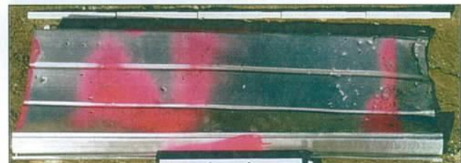
Abb. 12: Versuchsergebnis: senkrecht nach oben fliegende Splitter
