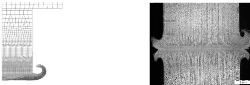
**Abbildung 16: ORS: berechnete Verformung (links) und Längsschliff (rechts)**
