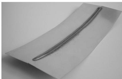
**Abbildung 1: Schweißbedingter Verzug der Platte**
