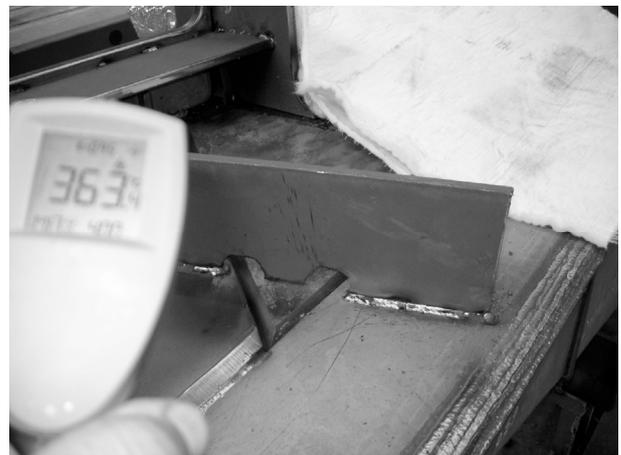
**Abbildung 13: Kontrolle der Vorwärmtemperatur**
