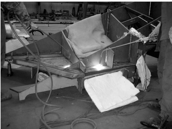
**Abbildung 12: Vorwärmung der „Support Plates“ für die Stopperplatte**
