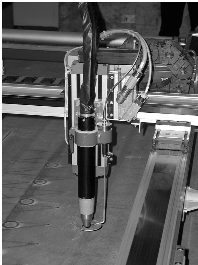
**Abbildung 8: Plasmabrenner zum Richten, befestigt an der Y-Achse (links in der Abbildung Kreise als Wärmefigur)**
